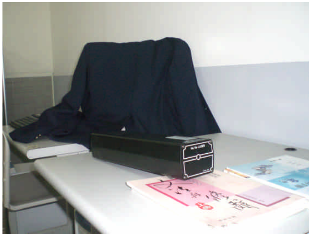
圖 3-(e) 氦氖雷射 (632.8nm，紅光)
